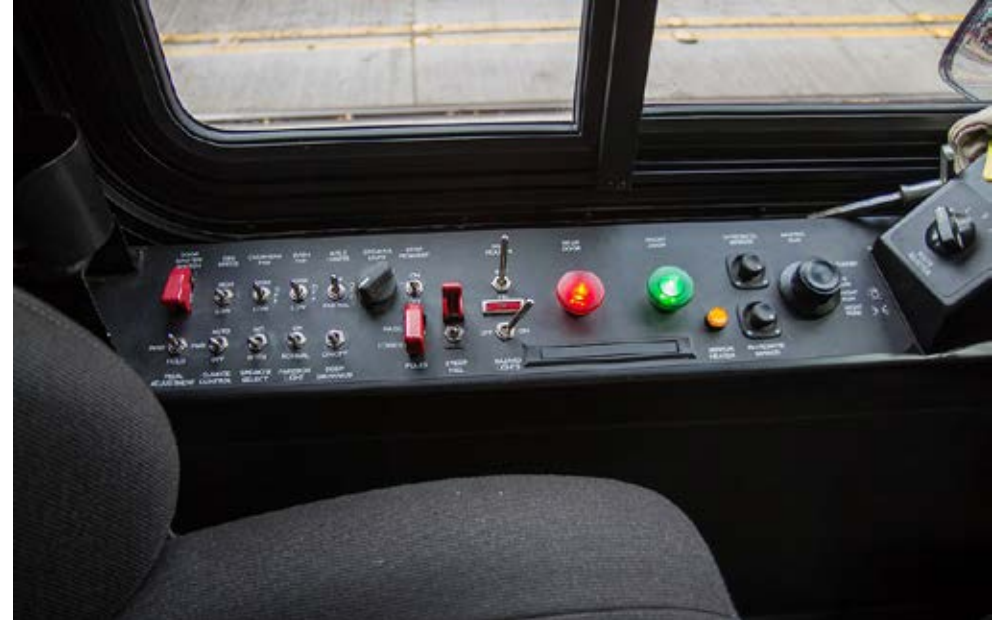
Schaltfläche eines öffentlichen Busses. Die wichtigsten Schalter und Signalleuchten heben sich farblich stark von der schwarzen Oberfläche ab.
