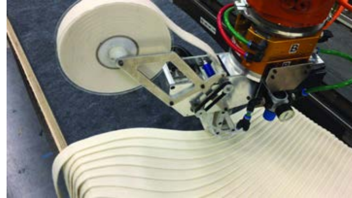
CNC-Nadelfilzer beim zusammenfügen einzelner Filzstreifen, sowie ein damit entstandener Sitzsack.
